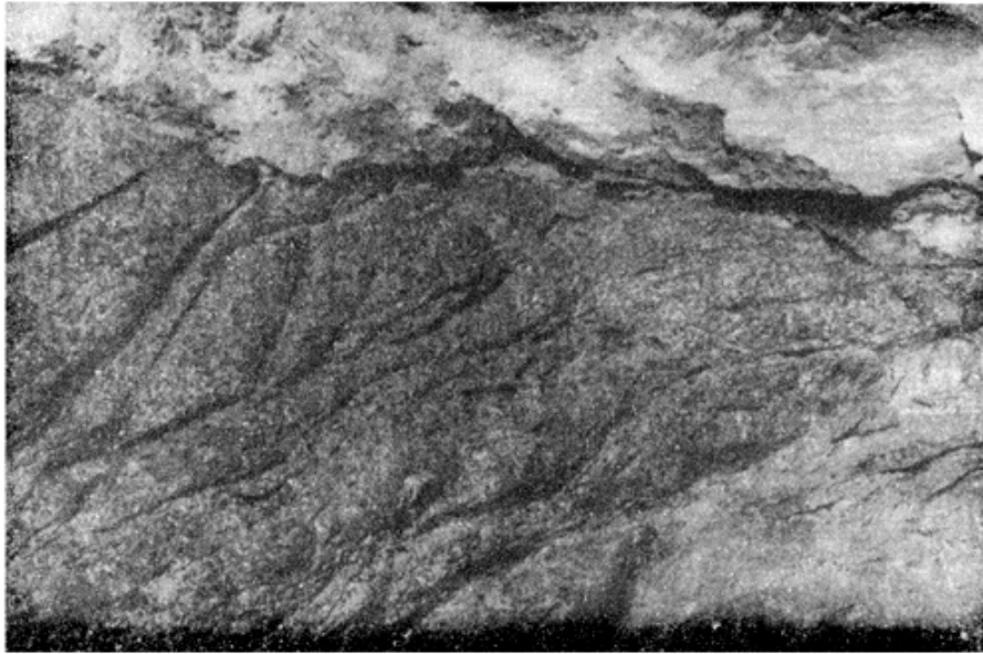
Рис. 2. Прибрежно-морские пески со сложной седиментационной текстурой, пропитанные льдом-цементом, в разрезе террасы с абсолютной высотой поверхности 12-14 м у пос. Харасавэй (западное побережье п-ва Ямал)
