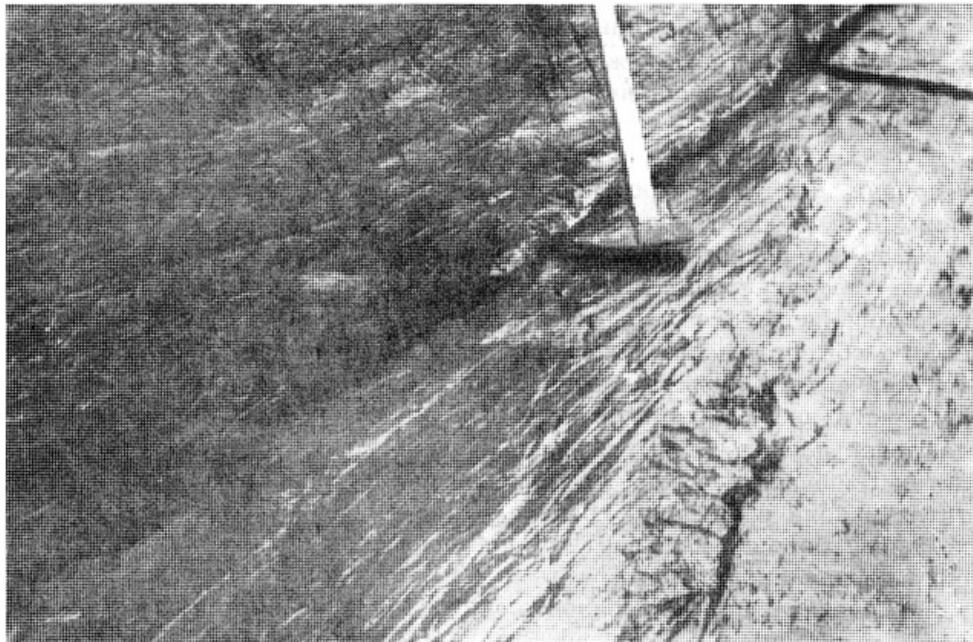
Рис.6. Четкое блоковое строение зеркала скольжения с параллельными бороздами на горизонтальной и вертикальной стенках взброса на габбро-норитах, о.Высокий, Северная Карелия.
