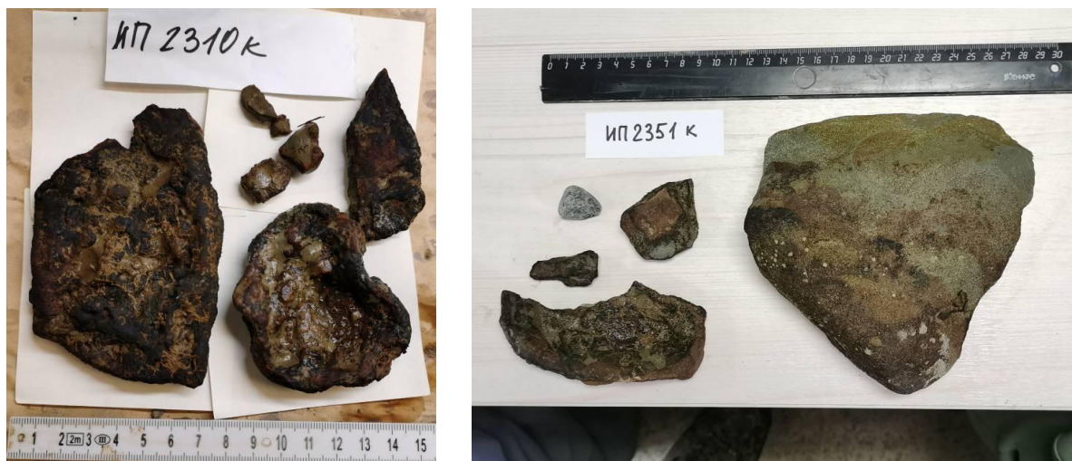
Рис. 9. Донный каменный материал (ДКМ) с некоторых станций донного опробования, полученный в рейсе в 2023 году: слева - станция ИП-2310К, железо-марганцевые корки, справа - станция ИП-2351К, мезозойские песчаники.
