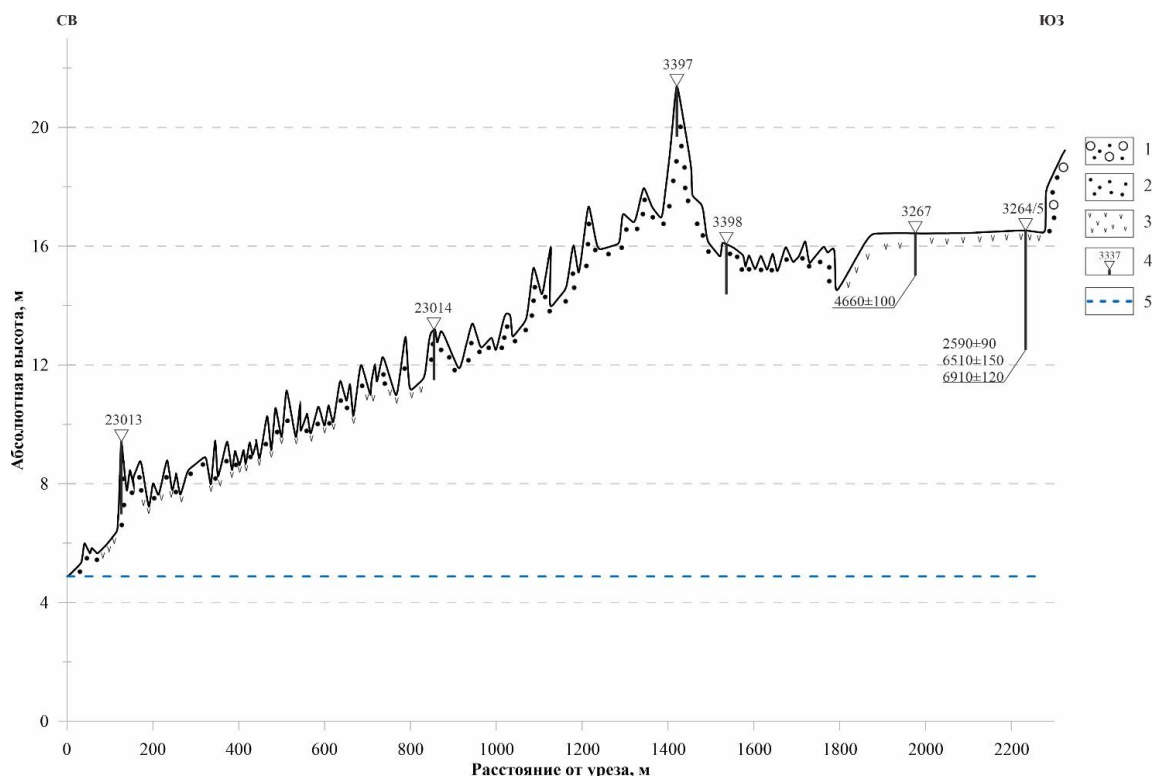
Рис. 2. Геоморфологический профиль береговой системы Тайпаловского залива. Условные обозначения: 1 – пески с гравием и галькой; 2 – пески; 3 – отложения торфяников 4 – места отбора образцов с глубиной отбора; 5 – уровень Ладожского озера в день съемки
