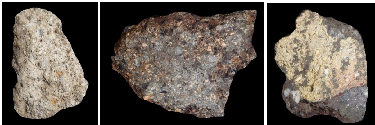
Рис. 25-27. Образцы аргилитоподобных техногенных флюидолитов и следы их выветривания из верхней части структуры
