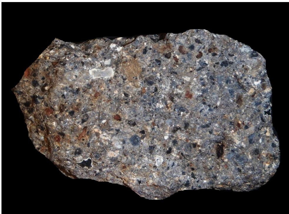
Рис. 17. Структура пород блочных массивных техногенных пород Кировской структуры. Образец из южной части основания структуры. Диаметр включений 1-10 мм
