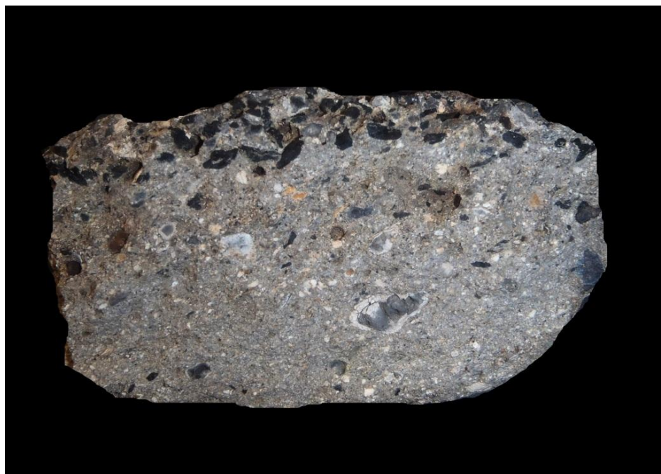
Рис. 18. Структура пород массивных техногенных флюидолитов Кировской структуры. Образец из северной части основания Кировской структуры. Черный цвет имеют угли образовавшиеся в результате частичного оплавления прослоя голоценового торфа и древесных остатков флюидными потоками. Диаметр включений 1-10 мм
