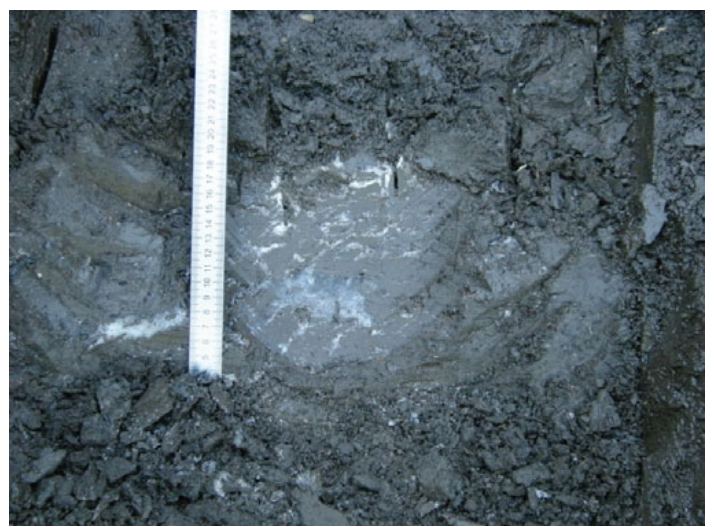
Рис. 15. Линзы и шлиры льда в нижней части пачки озерных суглинков в разрезе 7-метрового многолетнемерзлого торфяного бугра в долине реки Турумакит (фото Т.Ю. Репкиной)
