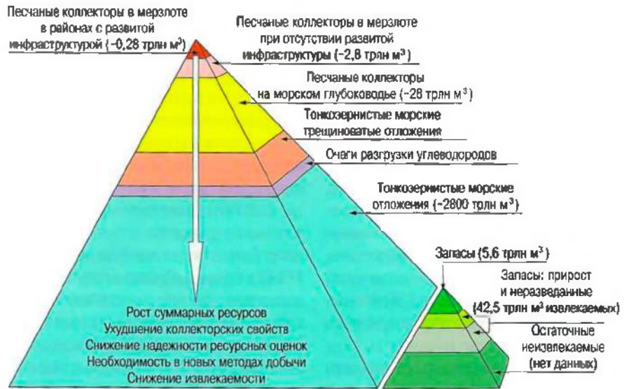
Рис. 2. Пирамиды глобальных ресурсов газовых гидратов (слева) и запасов газа различных источников, исключая гидраты (справа) [7]
