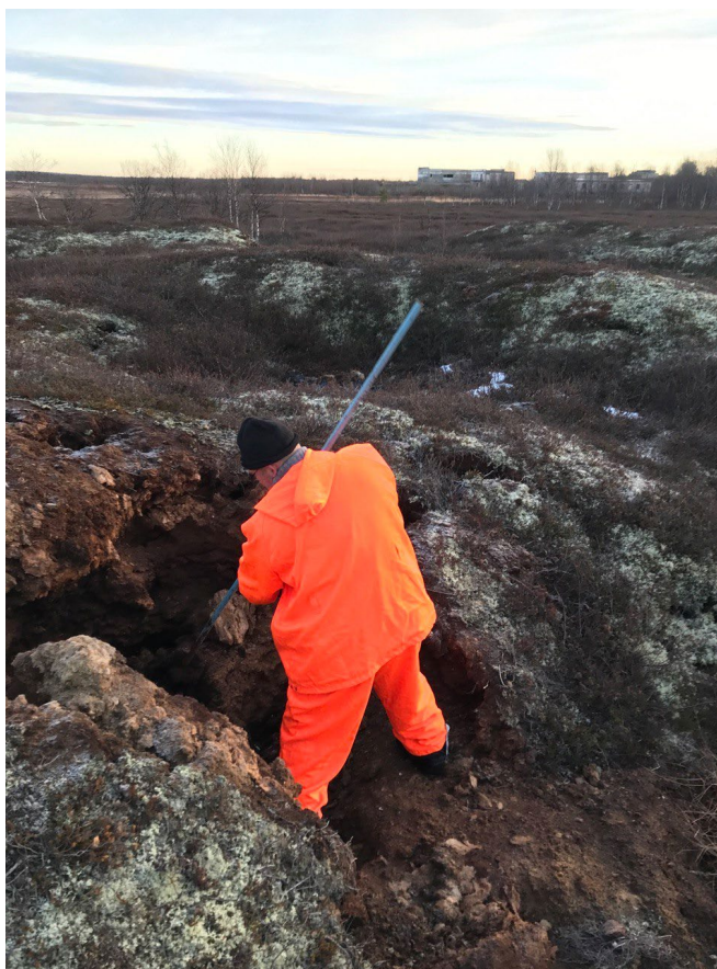
Рис. 1. Проходка шурфа на многолетнем торфяном бугре пучения в пос. Ловозеро.
