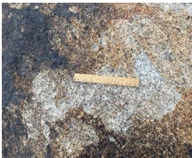
Рис. 22. Поверхность камня, с которого была взята проба на датирование по ^{10}Be и ^{26}Al . Свежий скол на фоне линейки – это место отбора пробы на датирование.
