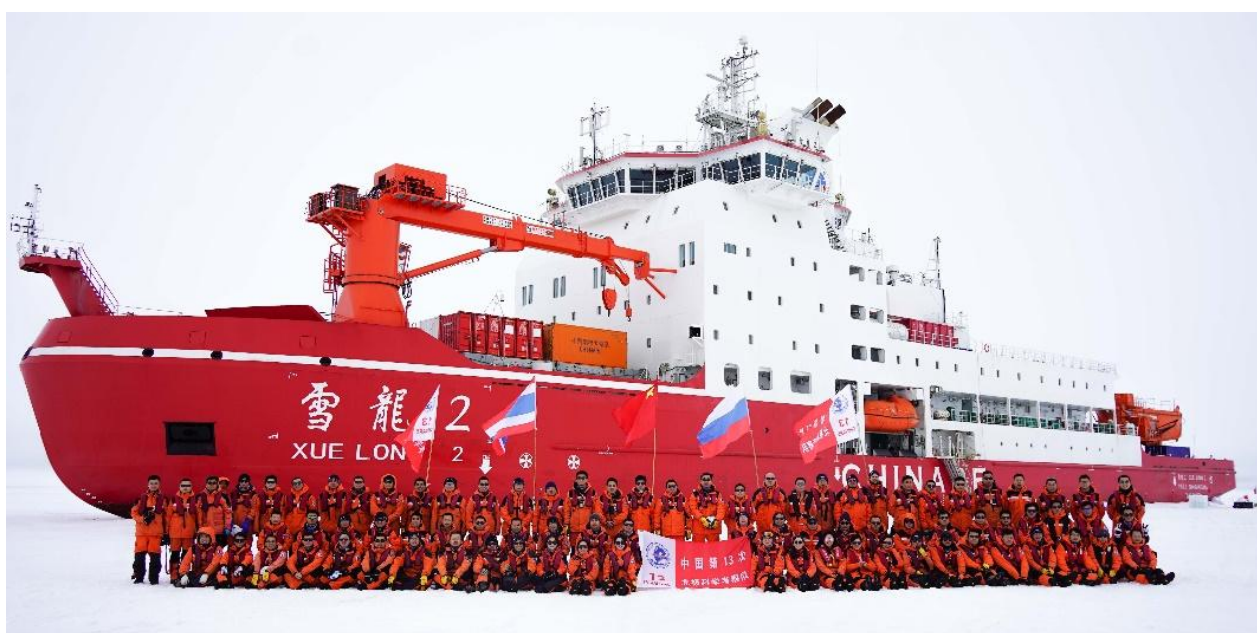
Рис. 2. НИС «Xue Long 2» - ледокол третьего ледового класса с гибридной дизель-электрической силовой установкой, специально созданное для геолого-геофизических работ.
