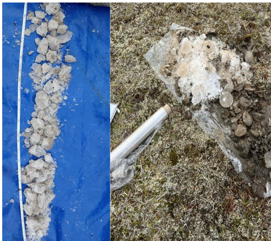
Рис. 5. Наличие трещинного льда, подтвержденное бурением. Глубина 1-2 м
