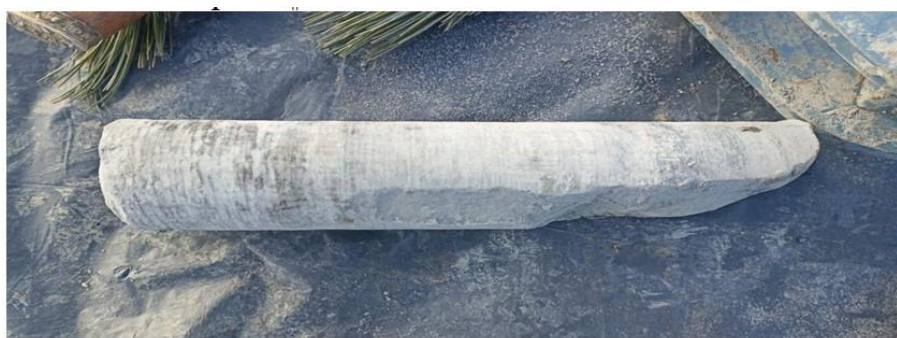
Рис. 7. Керн скального грунта с глубины 10м, метеостанция «Игарка».
